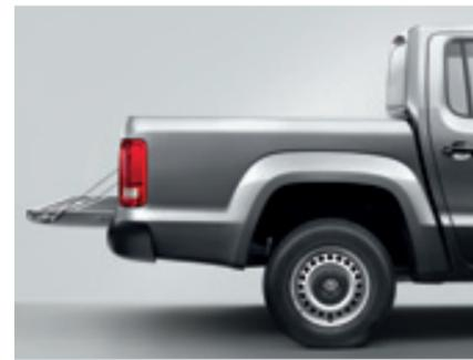
Die Ladekantenhöhe und Ladebordwandhöhe. Die Ladekantenhöhe ist mit 780 mm sehr niedrig, sodass ein leichtes Be- und Entladen möglich ist. Außergewöhnlich hoch ist die Bordwand mit 508 mm. So lässt sich auch Schüttgut gut transportieren.
