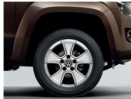
Das **Offroad-Paket I**. Damit Sie auf Feldwegen und im Gelände noch sicherer unterwegs sind, lässt sich der Amarok mit einem robusten Offroad-Paket ausstatten. Es umfasst einen Unterfahrschutz für den Motor und das Getriebe sowie eine 245/70 A/T-Geländebereifung auf 16"-Leichtmetallrädern „Amazonit“. Dieses Paket ist für den Amarok mit Hinterradantrieb sowie den Amarok mit permanentem 4MOTION Antrieb erhältlich.
