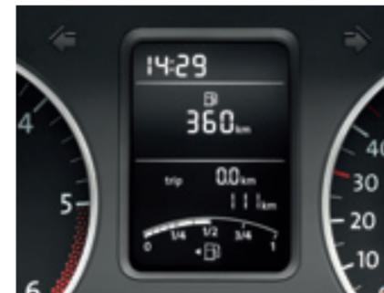
Das **Technikpaket**. Es besteht aus einer Geschwindigkeitsregelanlage und einer Multifunktionsanzeige. Letztere versorgt Sie mit zahlreichen Informationen, die helfen, ökonomisch und sicher zu fahren. Dazu zählt u. a. der durchschnittliche Kraftstoffverbrauch.
