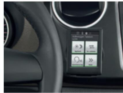
Die **Bluetooth-Freisprecheinrichtung „Touch Phone Kit“** für Mobiltelefone. Das 2,8"-TFT-Farbdisplay mit Touchscreen sowie präziser Sprachsteuerung sorgt für hohen Bedienkomfort (handyabhängig). Nur für RCD 210 und RCD 310.
