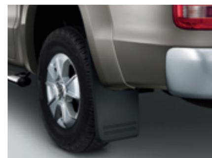
Die **Schmutzfänger vorn und hinten**. Sie sind aus Kunststoff gefertigt, an der Innenseite der Radkästen befestigt und schützen Ihr eigenes und die folgenden Fahrzeuge vor hochschleuderndem Schmutz und Steinen.
