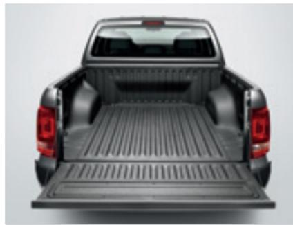
Die Laderaumbeschichtung. Direkt auf den Lack gespritzt, schützt diese anthrazitfarbene, UV-beständige Spezialbeschichtung den Laderaum vor mechanischen und chemischen Gebrauchsspuren.
