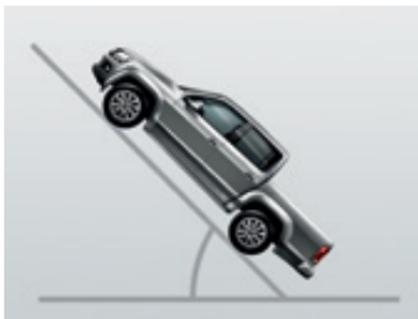
Der **Steigungswinkel**. Der Amarok nimmt es mit fast jedem Berg auf. Und Ihre Ladung gleich mit: Denn selbst mit einer Anhängelast von 2,8 t sind 12 % Steigung für ihn kein Problem. Er bezwingt Anhöhen mit 100 % Steigung (45°) sogar mit 1 t Zuladung.
