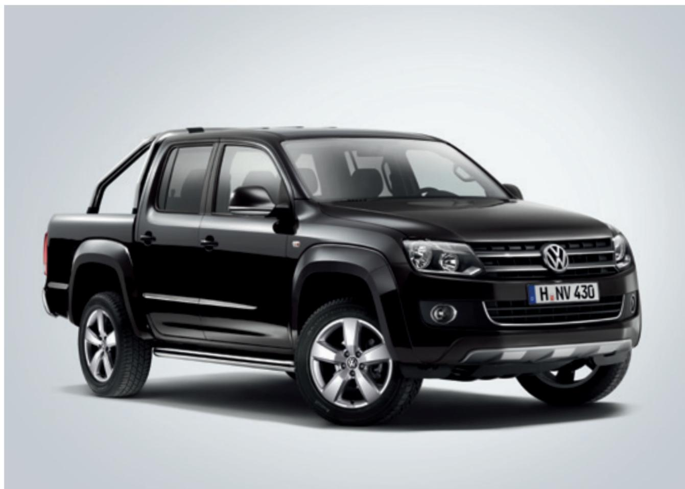
Das **Exterieurpaket in Chrom II**. Mit den eleganten Applikationen und Anbauteilen aus Edelstahl werten Sie Ihren Amarok zusätzlich optisch auf. Das Paket umfasst eine glanzpolierte StylingBar in Doppelrohrausführung und zwei Schwellerrohre in Chromoptik sowie den zweifarbig lackierten Unterfahrschutz „Design“, der sich im Frontbereich über die gesamte Fahrzeugbreite spannt.
