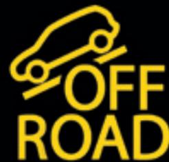
Das **Offroad-ABS**. Zusätzlich zum serienmäßigen Antiblockiersystem ist für den Amarok ein Offroad-ABS erhältlich, speziell entwickelt für den Fahrzeugeinsatz auf unbefestigten Wegen. Sobald die Funktion – per Tastendruck – aktiviert wird, vergrößert sich zum Beispiel das Bremsintervall. Die Räder blockieren kontrolliert, sodass der lose Fahr-bahnbelag verschoben wird und sich Bremskeile vor den Rädern bilden. Das kann den Bremsweg wesentlich verkürzen.
