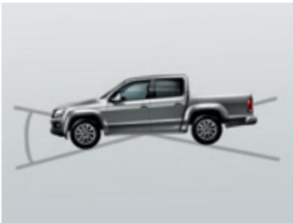
Der **Rampenwinkel**. Der Amarok bringt Sie gut über Stock und Stein. Und über alles, was deutlich größer ist. Bei einem Rampenwinkel von 23°<sup>2)</sup> sind selbst Baumstämme und Felsen kein Hindernis mehr.
