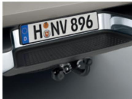
Die **Anhängervorrichtung**. Sie ist mit einer Anhängelast von bis zu 2.800 kg bei 12 % Steigung so robust wie der Amarok selbst. Bei Fahrzeugen ohne Heckstoßfänger wird die Anhängerkupplung mit einem Rempelrohr geliefert.
