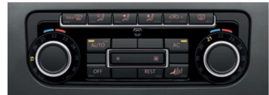
Die **Klimaanlage „Climatronic“**. Dieses System bietet eine 2-Zonen-Temperaturregelung für Fahrer und Beifahrer. Es erkennt die Stärke der Sonneneinstrahlung und die Außentemperatur und führt entsprechend mehr oder weniger kühle Luft zu. Die automatische Umluftschaltung und der Luftgütesensor schaffen ein angenehmes Klima.
