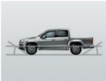
Der **Böschungswinkel und die Wattiefe**. Der Amarok trotzt steilen Hügeln ebenso wie kleinen Furten. So beeindruckt der Amarok mit einem Böschungswinkel von 28° vorn und 23,6° hinten (28° hinten ohne Stoßfänger) sowie einer Wattiefe von bis zu 500 mm.
