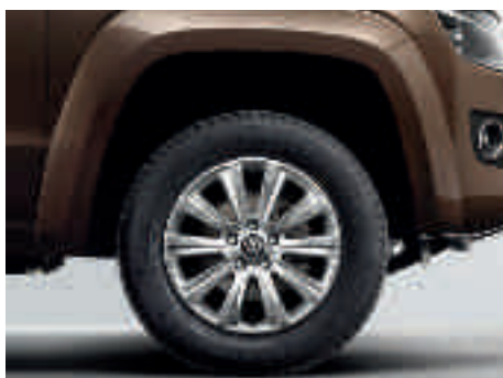
Vier lichtmetalen velgen Durban 7½ J x 18, inclusief wielkastverbreding. Voorzien van banden 255/60 R18 112T.
