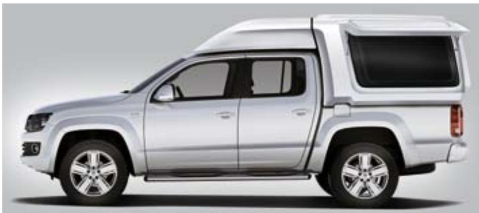
**Vario-Top Profi** mit großflächigen, abschließbaren Seitenklappen (GFK)
