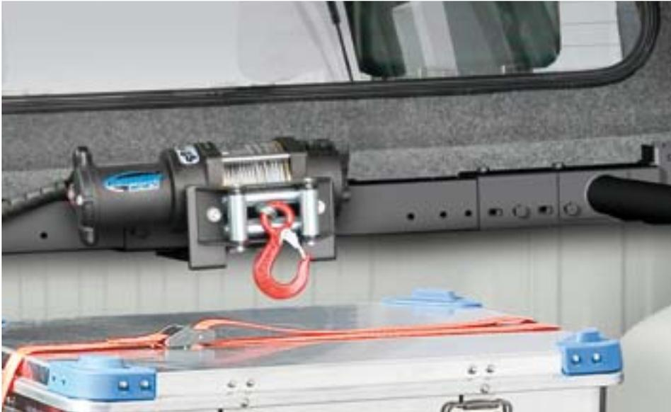
Der Trägerbalken kann auf der offenen Ladefläche oder im Hardtop montiert werden und bietet variable Befestigungspositionen für die kompakte Seilwinde.
