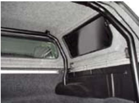
Der Lastenträger kann mit Road Ranger-Hardtops Typ RH3 und BacPac kombiniert werden. Die Basisträger werden in diesem Fall mit einem speziell dafür entwickelten Hardtop-Montagekit mit dem Lastenträgersystem unter dem Hardtop verbunden. Dadurch erhöht sich die max. Dachlast des Hardtops auf 150 kg - ideal bei schwerer Ladung im Gewerbebereich oder bei der Montage von Dachzelten.
