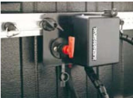
Relaiskasten und Batterie Hauptschalter auf Trägerplatte sowie der vorkonfektionierter Kabelsatz erleichtern die Montage.
