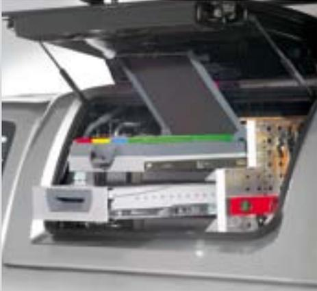
**Schubkombi** für die zweite Ladeebene mit Systemblech beidseitig, Schublade und entnehmbarem Kleinteilekoffer
