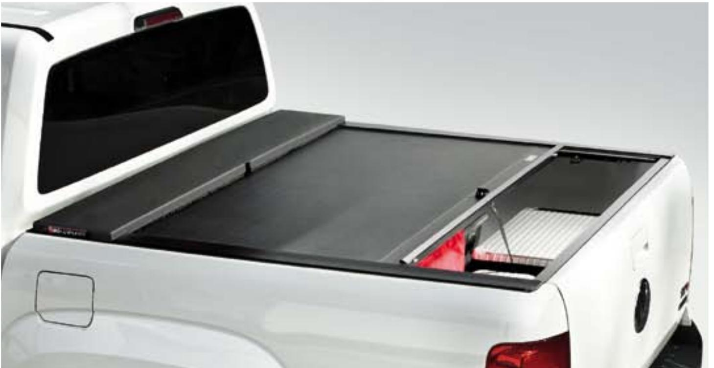
Regenwasserfestes, abschließbares Aluminiumrollo mit Vinylbeschichtung zum praktischen Abdecken der Ladefläche. Beim Öffnen rollt sich das Cover im Walzenbehälter auf - beim Schließen wird gleichzeitig die Heckklappe gesichert (Aufwändige Montage durch die zusätzlichen Wasserführungselemente). Art. 6000102
