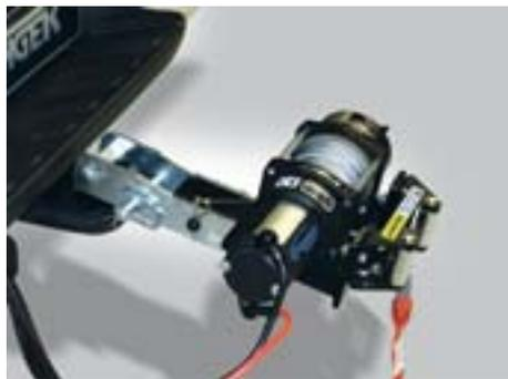
Mittels optionalem Adapter aus verzinktem Stahl kann die Winde alternativ auch an der Anhängerkupplung montiert werden.
