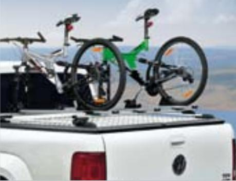
Bewährtes Cover aus Aluminium, mit sportlicher, umlaufender Reling und doppelseitigem Verschlussystem, belastbar bis 100 kg. Die Ladefläche bleibt optimal nutzbar, da das Cover binnen einer Minute wieder demontiert werden kann.
