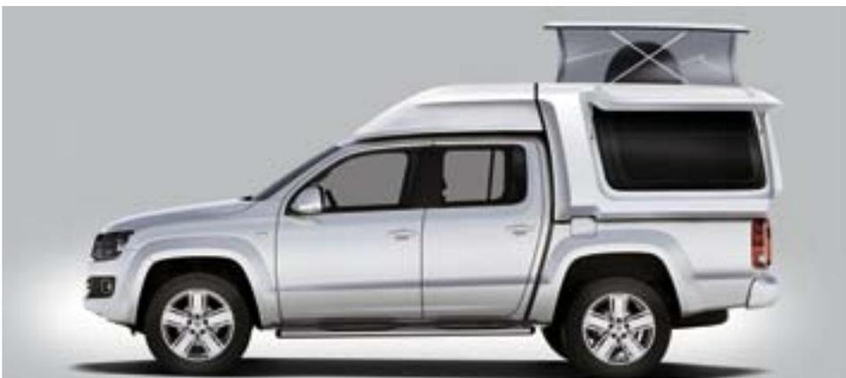
**Vario-Top Profi mit Hubdach** und abschließbaren Seitenklappen
