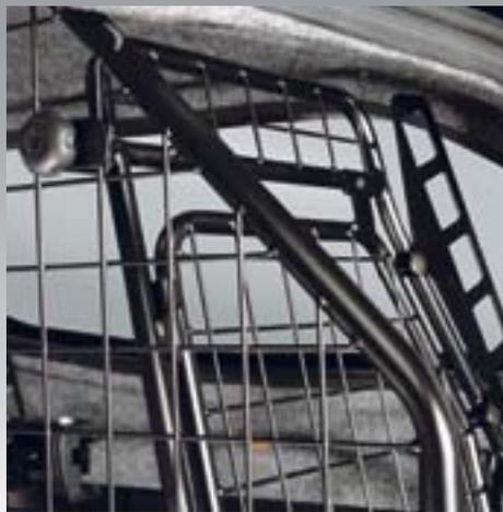
Die 3-teilige Gitterbox aus schwarz pulverbeschichtetem Stahl wird im Hardtop montiert und besteht aus einem Prallschutzgitter am Bug, Seitengitter und Türelement am Heck. Die Bug- und Heckelemente sind flexibel einstellbar - dadurch lässt sich die Boxlänge für jede Hundegröße individuell variieren und gewährleistet ein Optimum an Sicherheit.
